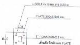
ขยายฐานรากยึดเสาโครงสร้าง
