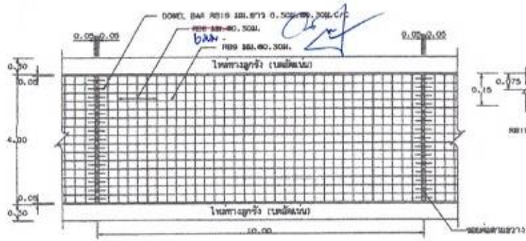
รูปแปลนแสดงการเสริมเหล็กและข้อต่อ
